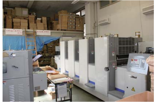
弊社工場内です。右に見えるのは四色（カラー）印刷機。左手前に見えるのが、単色の両面印刷機です。
